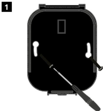
Inserir parafusos de fixação através dos orifícios de montagem da base de potência e apertar.
